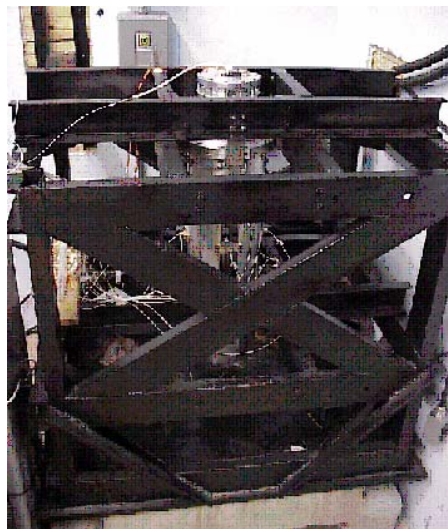
Figure 1. Flexible Rotor and AMB Control Test Rig
